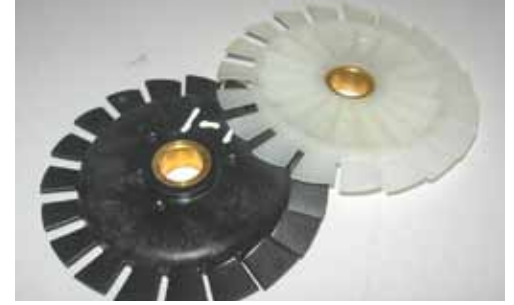
图19 产品转角内圆角半径优化后的注塑成型产品
