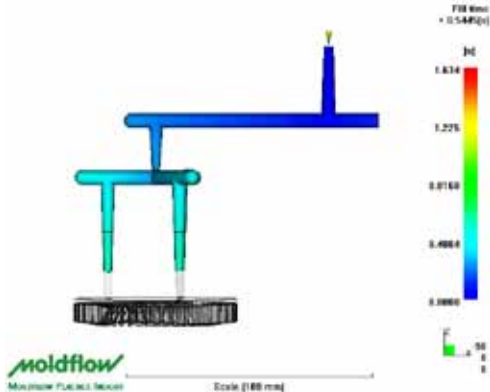
图8 浇注系统流动平衡
