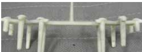
图2 浇注系统流动不平衡现象
